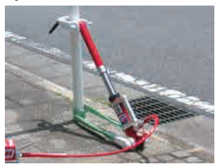
「道路標識起し機」。倒れた標識についてテレビのニュース番組から電話取材も
